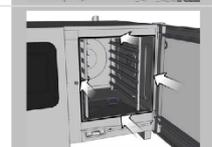
Wenn alle Ecken eingesetzt sind, drücken Sie die Hygienesteckdichtung sorgfältig an den Geraden in die Führung. Achten Sie darauf, dass die Hygienesteckdichtung fest anliegt und keine Krümmungen oder Wellen vorhanden sind.
